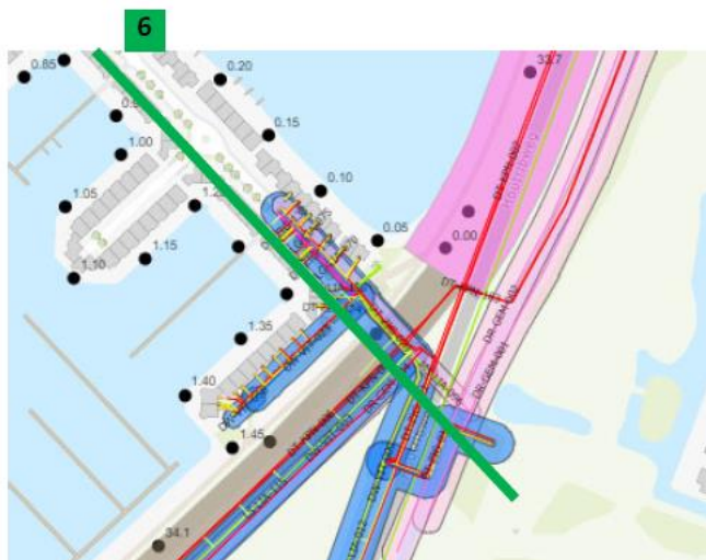
Figuur 3-6: Maatgevende leiding dwarsprofiel 6 – HM33,9
