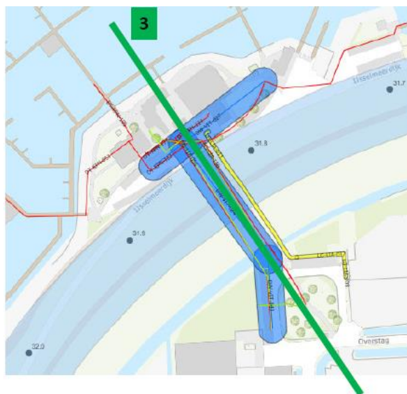
Figuur 3-3: Maatgevende leiding dwarsprofiel 3 – HM31,85
