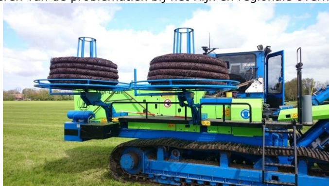
Biodrainage; buizen van biologisch materiaal
