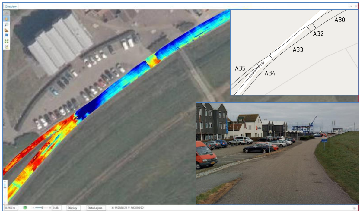
Figuur 9: Voorbeeld vakindeling (links asfaltdikte, rechtsboven vakindeling, rechtsonder foto situatie)
