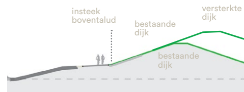
Bij verbreding van de dijk, de rechtlijnigheid van teen + beheerpad niet aantasten
