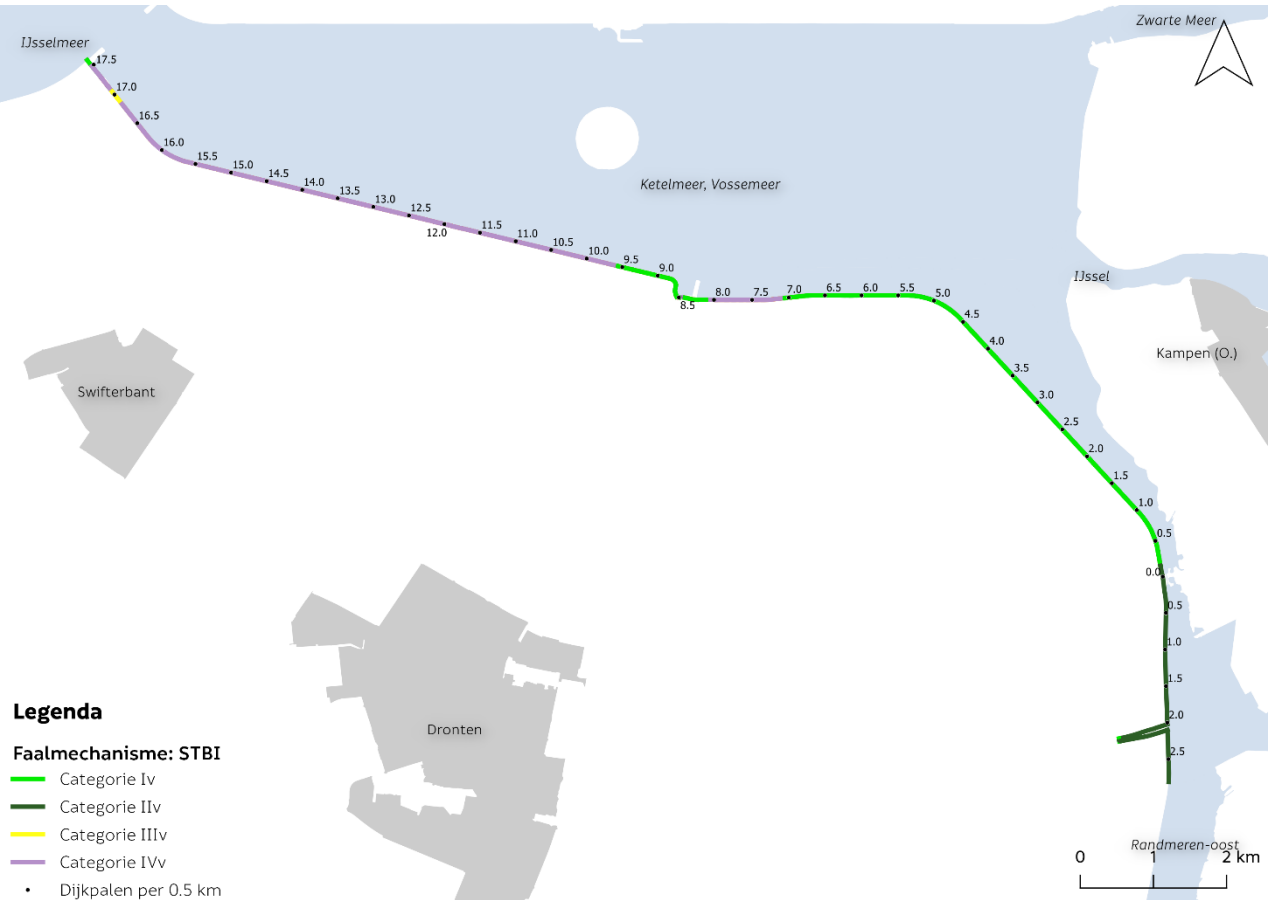
Figuur 2-6: LBO-1 Veiligheidsoordeel per vak voor marcostabiliteit binnenwaarts
