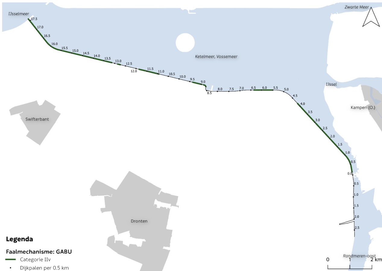
Figuur 2-13: Oordeel toetsspoor grasbekleding afschuiving buitentalud (GABU)
