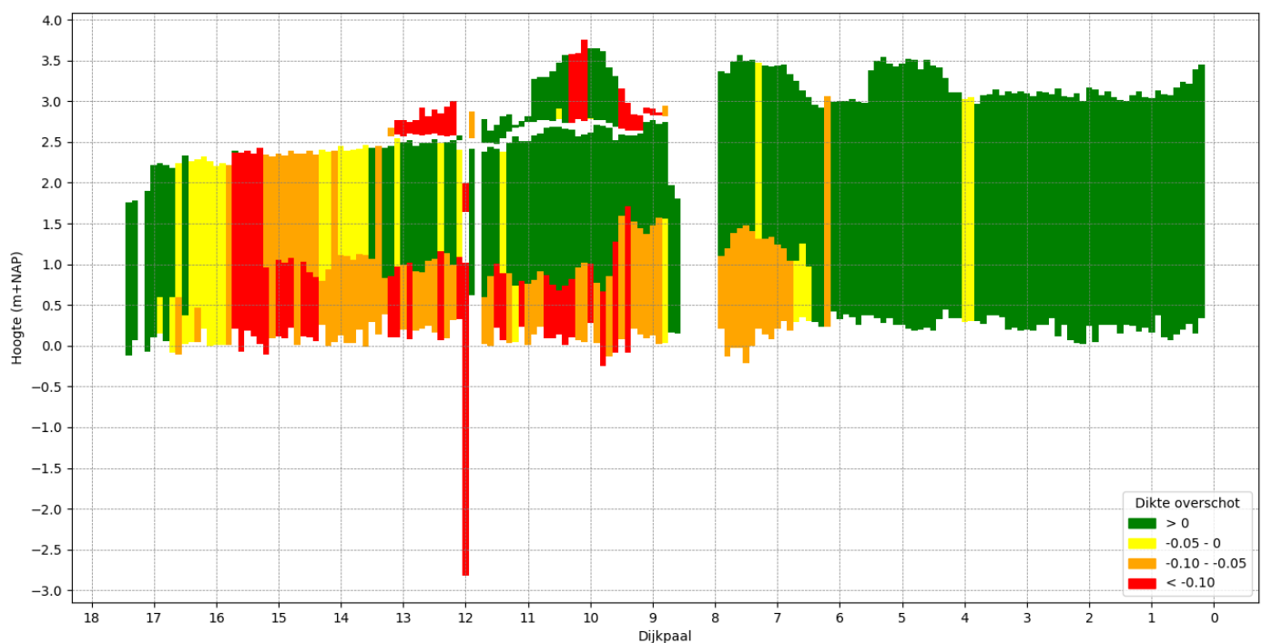
Figuur 2-27: Glooiingskaart resultaten Steentoets bij terugkeertijd 10.000 jaar, zichtjaar 2050.
