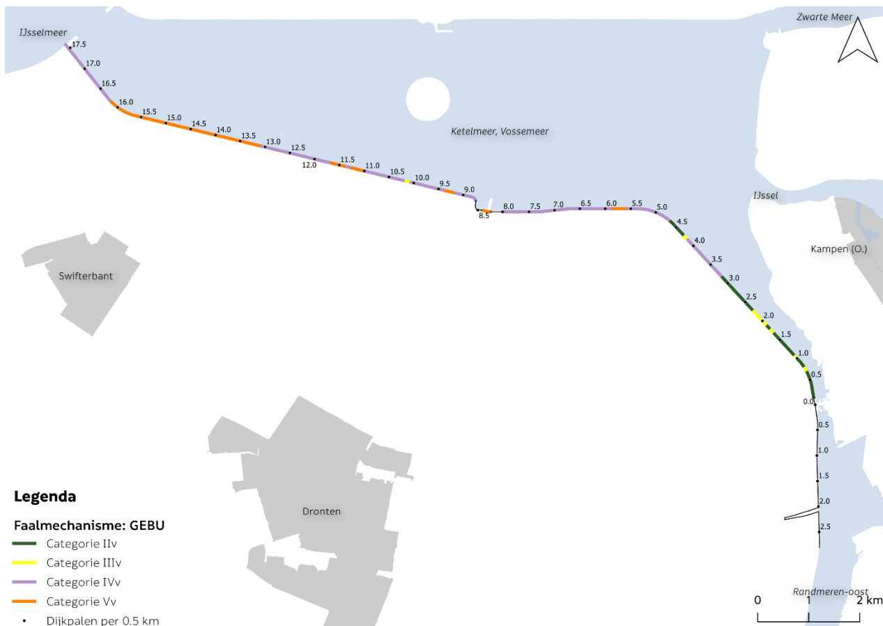
Figuur 2-12: Oordeel toetsspoor grasbekleding erosie buitentalud (GEBU)
