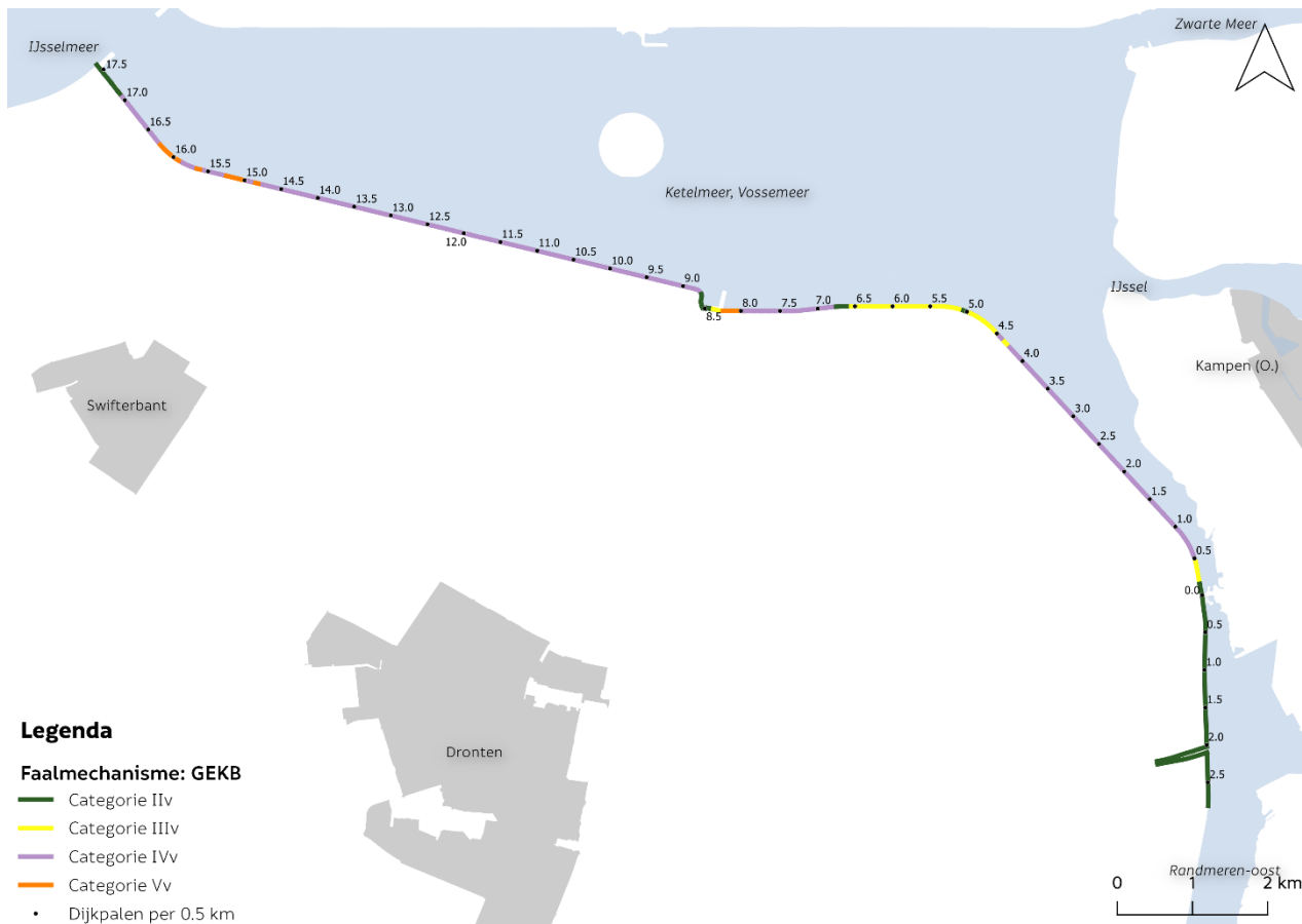
Figuur 2-14: Oordeel toetsspoor grasbekleding erosie kruin en buitentalud (GEKB).
